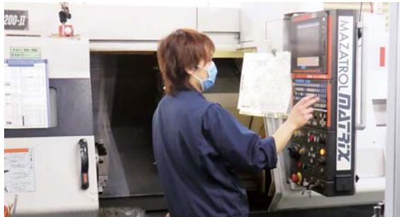
▲図面を見てCNC旋盤（コンピューター制御の旋盤）へのプログラム入力作業中
