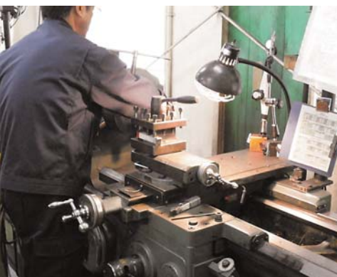
▲熟練の技を活かした汎用旋盤による金型の切削作業
