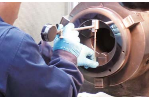
▲精密プレス金型の磨き作業と寸法測定
