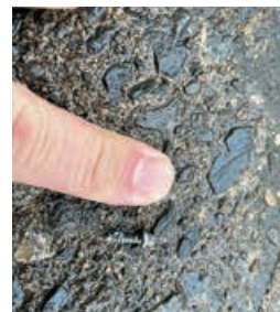
郵便局前MP場1号ポンプ他の故障(不織布、ネジ) ↑ →
