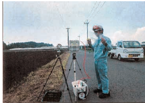
悪臭測定検査(持留地区)
